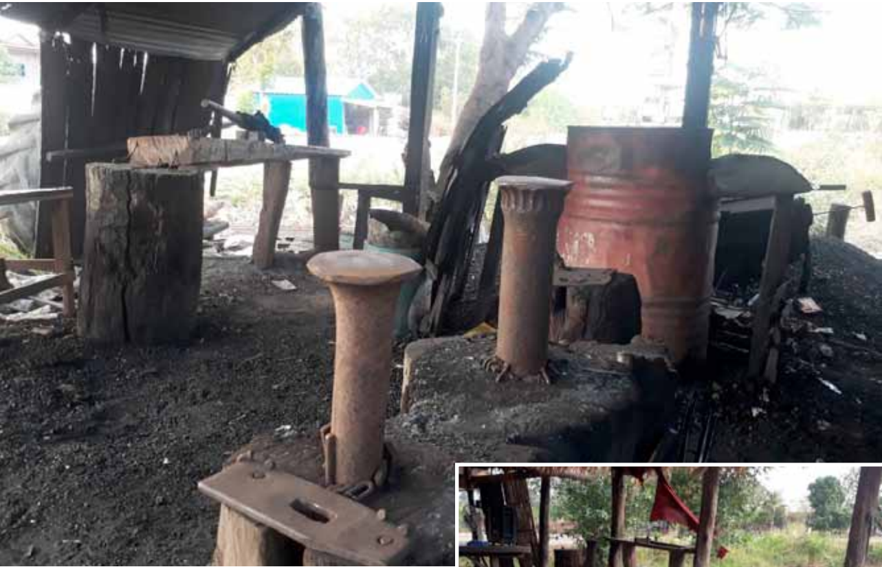
ទ្រាប់ដែក និង ឡសម្រាប់ដុតដែក ធ្វើកាំបិត និងឧបករណ៍ ប្រើប្រាស់ផ្សេងៗ (ស្លាក វិចិត្រ/ មជ្ឈមណ្ឌលឯកសារកម្ពុជា)
